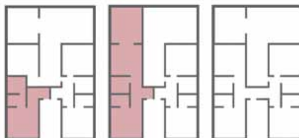
Grafik 8: Grundrissvariabilität durch Veränderung von Wandpositionen
