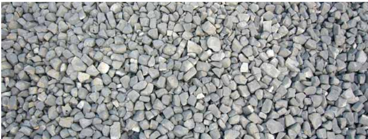
Abbildung 17: Mit Glasschaumschotter lassen sich lastabtragende Dämmungen herstellen, sodass gegebenenfalls auf ressourcenintensive Fundamentplatten verzichtet werden kann.
