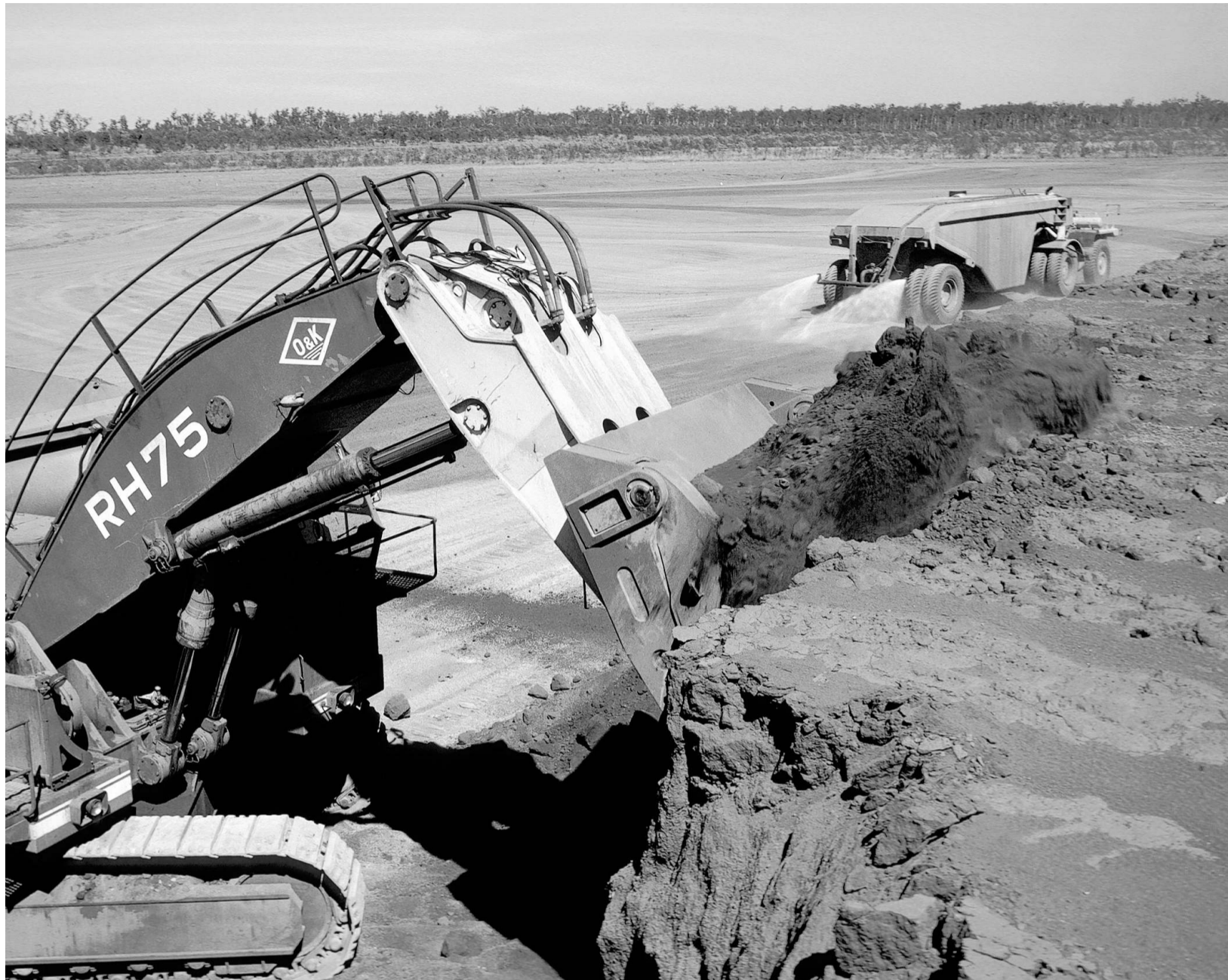
Der Ursprung vieler Alltagsprodukte: Hier wird der Rohstoff Bauxit gefördert. Aus etwa 95 Prozent dieses Bodenschatzes stellt man Aluminium her. Für eine Tonne Aluminium werden vier Tonnen Bauxit benötigt. Ein zu hoher Ressourcenverbrauch, sagen Umweltschützer. Foto: imago/photoshot/balance
